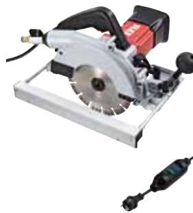
CS 60 WET Przecinarka z prowadnicą do cięcia na mokro kamienia naturalnego i sztucznego z wyłącznikiem PRCD, z możliwością cięcia pod kątem 45° Zamówienie nr 374.016
